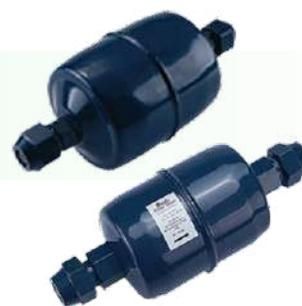
Durante el funcionamiento, es preciso recoger y eliminar suciedad y humedad. El filtro deshidratador se instala normalmente en la línea de líquido, donde su función principal consiste en proteger la válvula de expansión.
