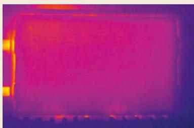
Gracias a la baja conductividad del EPP, hay menos pérdidas de calor en la zona del colector.
