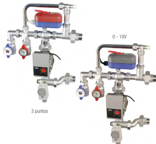
Este grupo de regulación modulante está indicado para el suministro de agua a baja temperatura a los circuitos de una instalación radiante. Incluye las conexiones de ida y retorno para el montaje directo a un colector de climatización radiante, así como las conexiones para la recepción de agua caliente y de retorno (estas últimas dotadas de llaves de corte de tipo esfera).
