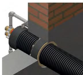
Uso: elemento estanco al agua para paso de la tubería preaislada ALB a través de muros que asegura el sellado en caso de agua presurizada. El sistema de sellado se basa en una serie de uniones que se expanden para ejercer presión contra el muro al atornillar los tornillos.
