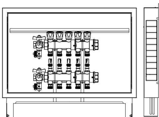
Colector ALB ULTRACOMPACTO 2+3 en caja metálica
