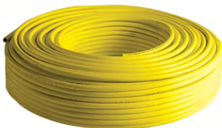
Tubo multicapa color amarillo para sistemas de canalización de tuberías multicapa para instalaciones receptoras de gas con una presión máxima de operación (MOP) inferior a 5 bar (500 kPa), formados por tubos multicapa, accesorios y sus uniones. Diámetros disponibles 16 x 2,0, 20 x 2,0, 26 x 3 y 32 x 3,0 mm. Válido tanto para instalaciones vistas como empotradas, interiores o exteriores. El tubo es resistente a la intemperie y los rayos UV.
