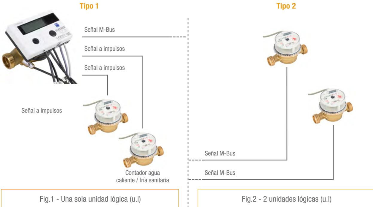
El protocolo M-Bus, único reconocido por el concentrador, obliga a que la señal transmitida por los contadores al concentrador sea M-Bus y no de impulsos. Cuando los contadores volumétricos con salida de impulsos van conectados a un contador de energía, el conjunto es visto por el concentrador como un solo elemento (una unidad lógica, Fig. 1). Si los contadores volumétricos tienen salida M-Bus y se conectan directamente a la red, cada uno es visto como una unidad lógica independiente (Fig. 2).
