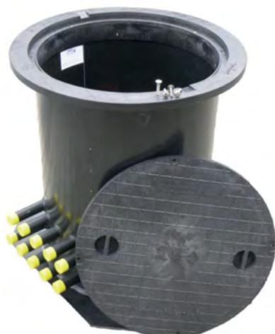
Arqueta para 5-12 sondas de geotermia con colectores incluidos. Completamente montada y lista para su colocación en obra. Fácil de instalar por un solo operario. Fabricada en PEHD (Polietileno de alta densidad), confiere al conjunto la robustez necesaria. Tapa transitable hasta 200kg certificada por TÜV, con bloqueo roscado, resistente al agua superficial y freática, con superficie antideslizante. Diámetro exterior 750mm. Diámetro interior 612mm (hasta 8 salidas) o 695mm (hasta 12 salidas).
