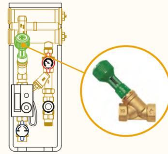
Con válvula alto Kv y equilibrado estático
