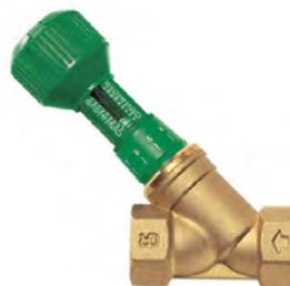
Válvula de equilibrado hidráulico de ajuste manual. Incorpora escala graduada de 0 a 8 posiciones. Función memoria en el pomo que permite mediante un tornillo fijar la posición de ajuste y recuperarla fácilmente si se manipula el mando.
