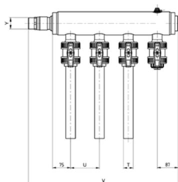
Colectores modulares fabricados en base a polietileno de alta densidad PE100 para conexión de sondas Ø40 (verticales) fabricadas en PE100 y con relación de diámetros SDR11. Conexión de dichas sondas mediante termofusión HS. Dotado de válvulas de bola. Incluye purgador R 1/2" y llave de llenado/vaciado.
