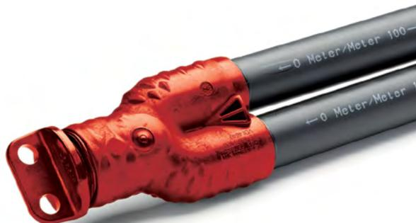
Las sondas geotérmicas de Polietileno de alta densidad (PE-RT) son de uso habitual y se encuentran ampliamente extendidas. La vida útil estimada de estas sondas para aplicaciones de sólo calefacción y para aplicaciones de calefacción/ refrigeración es de más de 100 años, siempre que la temperatura del fluido que circula en ellas no sea superior a 40°C. **Cabe mencionar que temperaturas superiores a 40°C no son habituales en instalaciones convencionales.**
