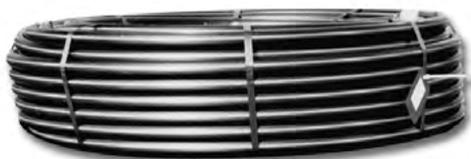
A utilizar conjuntamente con las sondas verticales. Fabricado en base a polietileno de alta densidad PE-HD, relación de diámetros SDR11 y PN16. Facilita la operación de llenado del pozo mediante la inyección en sentido ascendente del material de relleno, bentonita o similar.
