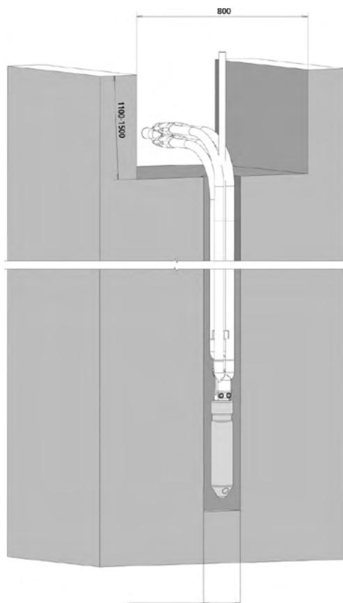
Sistema de sondas dobles para instalación vertical fabricadas en base a polietileno de alta densidad PE 100-RC, relación de diámetros SRD11 y PN16. La unión inferior en U es soldada en fábrica mediante proceso certificado según VDI 4640, pieza donde se ubica el correspondiente peso.
