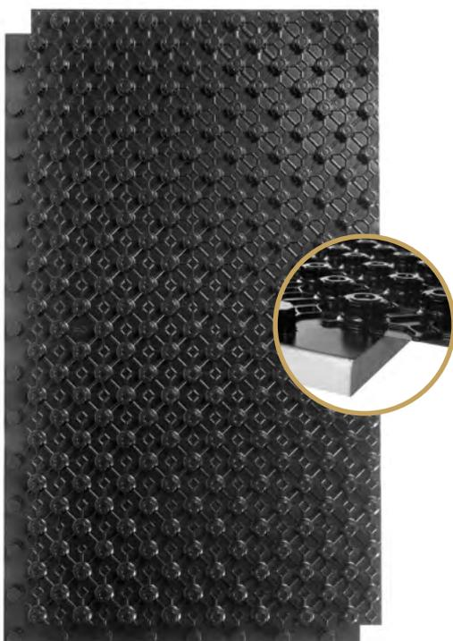
Panel aislante ALB con tetones, en poliestireno expandido, (EPS) autotextinguible (Euroclase E), de 10, 18, 22, 27,44 ó 50 mm de espesor útil. Provisto de tetones moldeados para la fijación del tubo con separaciones en múltiplos de 50 mm, y perfiles perimetrales machihembrados para el montaje; con lámina de poliestireno termoformado, color negro.
