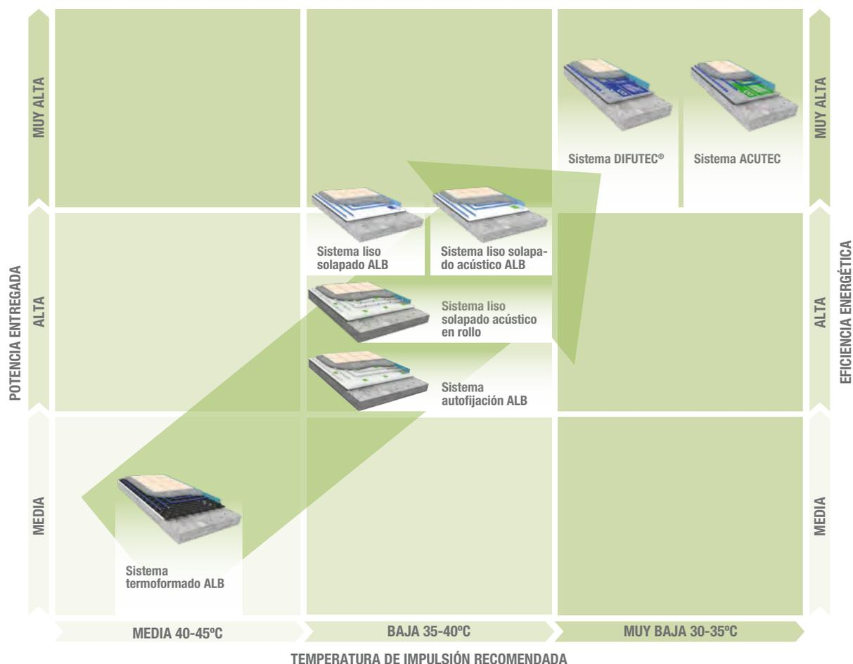
Gracias a la lámina difusora del calor, los sistemas ALB-DIFUTEC® y ALB-ACUTEC tienen la máxima potencia entregada y requieren la mínima temperatura de impulsión, siendo la combinación perfecta para las bombas de calor.
