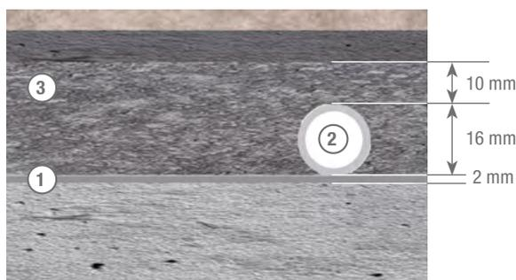
El sistema autofijación de bajo perfil ALB para rehabilitación está compuesto por una lámina autofijación basada en la tecnología tipo velcro de 2 mm de grosor. El tubo multicapa SUPERFLEX autofijación queda fijado a la misma gracias a la cinta que lo envuelve. El tubo SUPERFLEX, asimismo, posee una gran capacidad de flexibilidad y, por lo tanto, facilidad
