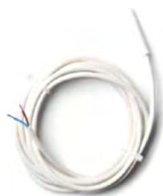
Sonda de pavimento de seguridad, permite parar la instalación si la temperatura del suelo está por encima (calefacción) o por debajo (refrescamiento) del valor configurado en el termostato ambiente. Va conectado directamente a la base de conexiones y se recomienda cable par trenzado de sección mínima 0,6 mm<sup>2</sup> y no superar los 30 metros de longitud total.
