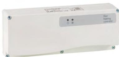
Permite centralizar la conexión de termostatos on/off cableados y los cabezales de los circuitos. Es el nexo entre todos los elementos de control de la regulación ambiente. Todos los elementos del sistema son cableados y funcionan en modo todo/nada. La base de conexiones dispone de una salida 230V para control de bomba circuladora y salida libre de tensión para dar señal a caldera o aerotermia.
