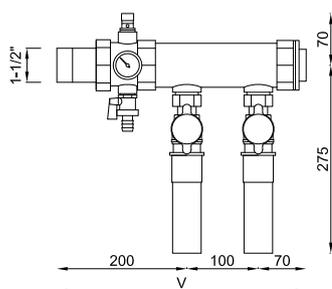
Colector modular 2" de 2 a 5 sondas fabricado en latón. Colector de ida con llave de vaciado, termómetro y purgador manual. Colector de retorno provisto de separador de lodos con llave de vaciado y pieza intermedia con purgador manual y termómetro. Conexiones a máquina macho 1-1/2" en la ida y hembra 1-1/2" en el retorno.
