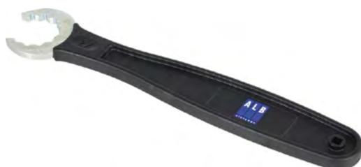
Llave de apriete universal Ø27 para los adaptadores de tubo multicapa de diámetros 14, 16, 17 y 20 mm (no apta para el adaptador del colector industrial Ø20x2 mm con rosca M33x1,5). Facilita el apriete y desenroscado de los mismos en las derivaciones del colector.
