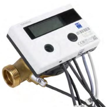
Contador de energía ALB de chorro simple, con aislamiento galvánico, para instalación vertical u horizontal, según MID 2004/22/CE Anexo MI-004. Módulo electrónico extraíble y configurable, con batería de 10 años de vida útil y posibilidad de ser sustituida, incorpora sonda de impulsión y sonda de retorno preconectadas.
