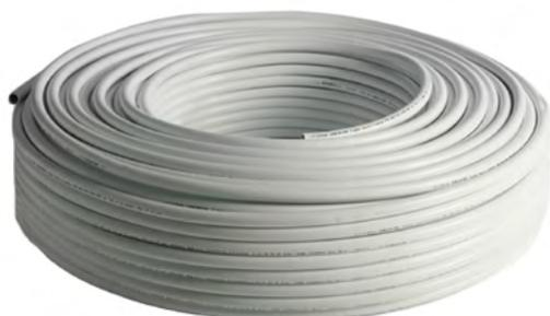
Tubo multicapa ALB blanco para climatización radiante, compuesto por una capa interior en polietileno PE-RT (DOWLEX 2388), una capa intermedia en aluminio de 0,2 mm de espesor, soldada a testa, y una capa exterior en polietileno (PERT)
