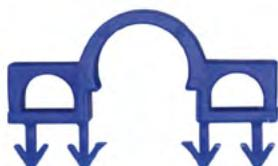
La nueva grapa ALB para rehabilitación, está especialmente diseñada para una sujeción extrema del tubo con una baja penetración en el panel. Sus cuatro patas hacen que resulte más fácil grapar sobre el aluminio. Además, su diseño aporta al conjunto un plus de resistencia frente las posibles deformaciones provocadas por la retracción del mortero.
