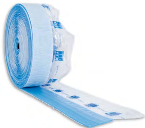
Fabricado en espuma de polietileno de celda cerrada; este material posee un coeficiente elástico adecuado para deformarse bajo la presión dilatométrica del mortero, y permitir su expansión sin que se produzcan efectos adversos en la construcción.
