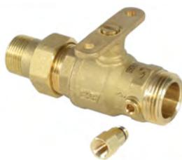
Las válvulas de zona de paso total se basan en el diseño de la válvula de bola, que proporciona una función de corte y de paso total en posición abierta, con giro de 90°. Estas válvulas se ofrecen en versiones de dos y de tres vías, en diversas con-
