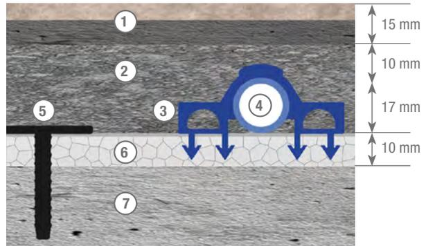
1. Baldosa y cemento cola / 2. Mortero ALB autonivelante\* / 3. Grapa ALB para rehabilitación
