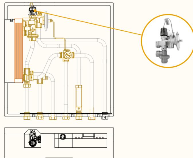
Con intercambiador de placas (configurado en caja)
