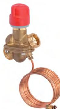
Válvula de presión diferencial combinada de equilibrado automático que incorpora un tubo capilar. Realiza 3 funciones: control de la presión diferencial del circuito al que abastece, control de zona y limitación de caudal. Admite el montaje de un cabezal termoeléctrico para su apertura y cierre.
