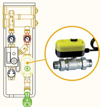
Con válvula de esfera motorizada (2 y 3 vías)
