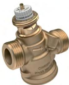
Válvula de equilibrado hidráulico dinámico que limita el caudal máximo de forma automática e independiente. Mantiene la presión diferencial a un valor constante una vez fijado un caudal en el volante. Admite el montaje de un cabezal termoeléctrico para su apertura y cierre.
