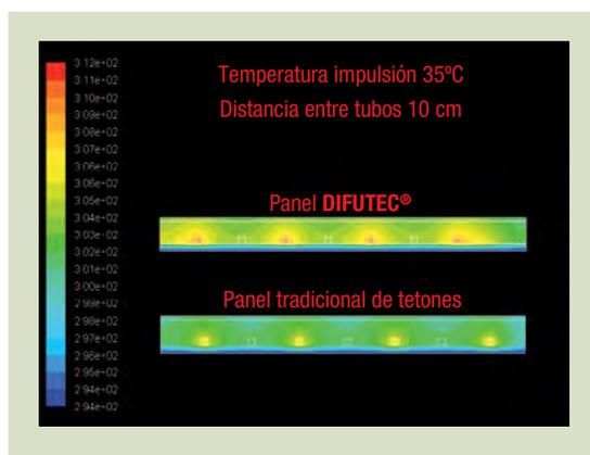
Se muestran a continuación los principales resultados térmicos obtenidos mediante esta simulación (basada en la norma UNE EN 1264) y los ensayos experimentales efectuados en APPLUS:
