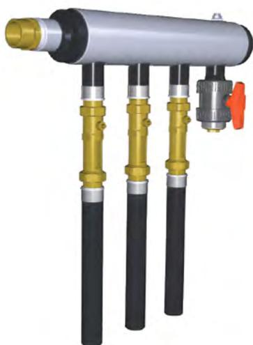
Colectores modulares fabricados en base a polietileno de alta densidad PE100 para conexión de sondas Ø40 (verticales) fabricadas en PE100 y con relación de diámetros SDR11. Conexión de dichas sondas mediante termofusión HS. Dotado de válvulas de equilibrado hidráulico Inline, obligatorias en caso de no compensar hidráulicamente las diferentes sondas geotérmicas mediante el diseño de retorno invertido. Incluye purgador R 1/2" y llave de llenado/vaciado.
