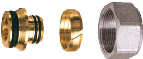
Adaptador para tubo multicapa 20 x 2 (mm), para colector de climatización radiante con derivaciones con rosca M33 x 1,5, para aplicaciones industriales.
