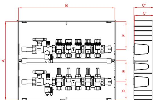
Colector ALB caudalímetro en caja de plástico
