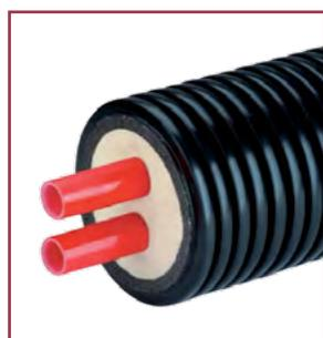
Gracias al tratamiento de la tubería interior de PE-Xa y al recubrimiento exterior del aislante basado en una hoja de aluminio, el sistema goza de prestaciones contra la difusión del oxígeno y no deberá presentar problemas de incrustaciones o sedimentos.
