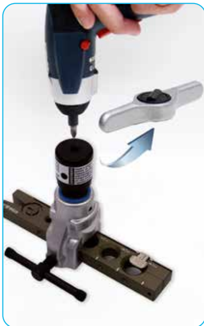
Posibilidad de trabajar con carraca manual o con herramienta eléctrica
